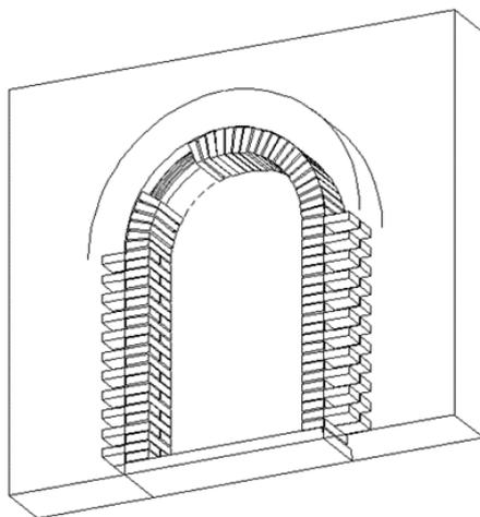
**A05060** Ricostituzione con metodo scuci-cuci di nervature di volte laterizie di mattoni posti a coltello, con geometria a crociera o botte lunettata, eseguito dal basso, senza l'ausilio di centine. Computato a m di nervatura trattata ..... m **210,00**
