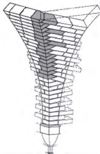
**A05061** Ricostituzione con metodo scuci-cuci del campo centrale di volte laterizie di mattoni posti a coltello, con geometria a crociera o botte lunettata, eseguito dal basso, senza l'ausilio di centine. Computato a m<sup>2</sup> di superficie trattata ..... m<sup>2</sup> **415,00**
