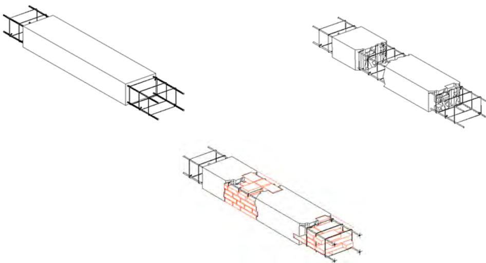
**A05067** Formazione di fascia di contenimento delle spinte orizzontali, per singole pareti, realizzata con profilato metallico collegato ai setti ortogonali mediante barre di acciaio filettate. Il profilo, posto sulla sommità della parete, avrà sezione a forma di L o T (altezza minima mm 100) e sarà appoggiato o parzialmente inserito al disotto dello sporto di gronda. Il profilato sarà dotato di paletti di ripartizione a sezione T (minimo mm 50) di lunghez-
