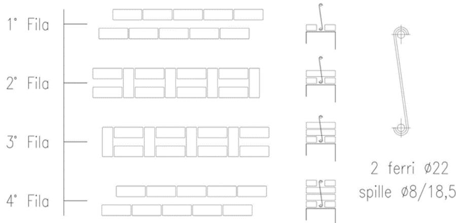
**A05065** Cordolo in acciaio e legno su muratura a una o due teste. Realizzazione di cordolo in acciaio e legno costituito da profilato UPN140 con inserito all'interno elemento in legno massello di essenza dura con funzione di "ammortizzatore" atto a favorire l'efficacia dei perfori verticali di collegamento con la muratura sottostante e la
