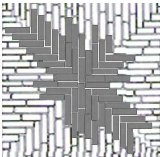
**A05062** Ricostituzione con metodo scuci-cuci di spigoli di volte laterizie di mattoni posti in foglio, con geometria a crociera o botte lunettata, eseguito dal basso, senza l'ausilio di centine. Computato a m di nervatura trattata ..... m **150,00**
